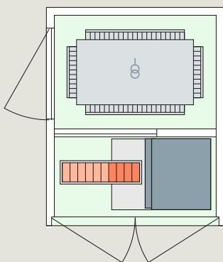
На рисунке наглядно показана экономия места для четырех низковольтных шин или одного средневольтного кабельного ответвления при использовании распределительного устройства 8DJH шириной 700 мм по сравнению с традиционным устройством распределения нагрузки шириной 1050 мм
